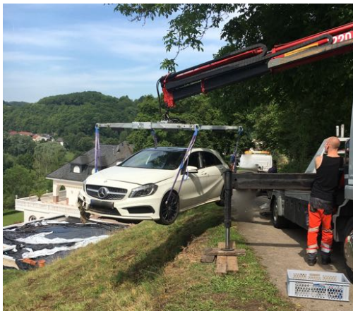
Bergung mittels Ladekran, Takler und schonenden Bergegurten
