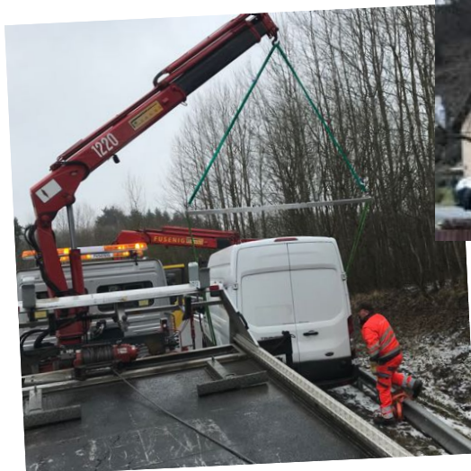
Doppelhub eines Transporters mittels zwei Ladekränen
